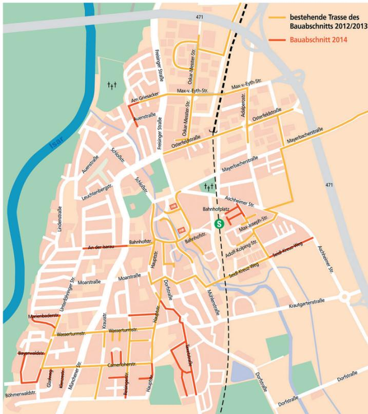
Während derzeit noch die letzten Straßenbaustellen geschlossen werden, ist der Bauabschnitt 2014 bereits fertig geplant. Annähernd sieben Kilometer Fernwärmenetz werden im kommenden Jahr gebaut und ermöglichen den Anschluss von rund 350 Gebäuden aller Art und Größe. Von der möglichen Anschlusszahl her ist dieser Bauabschnitt der größte seit Baubeginn im Frühjahr 2012.
